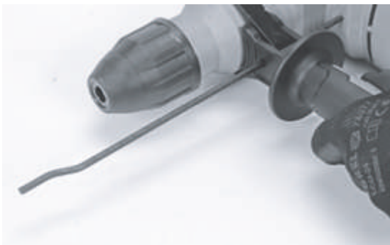
Рисунок 4. Встановлення обмежувача глибини свердління.
